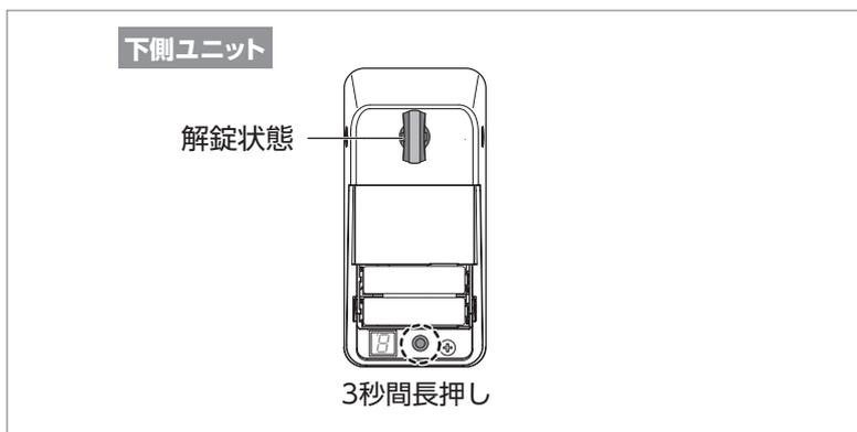
⑦ 表示部に **b** (BLE 設定) が表示されるので、表示されたら長押しで決定してください。
